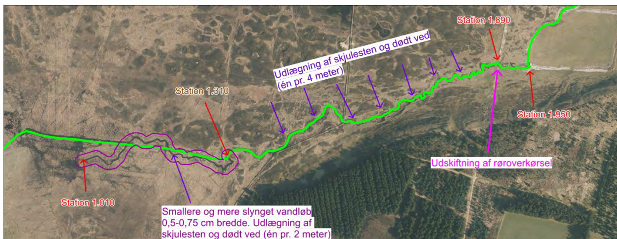
Figur 2.4.3.1: Restaureringstiltag på strækning 1 (Sokland Bæk).
